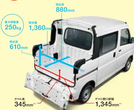
荷台の固縛に便利なガードフレーム/ガードバー/テールゲートフック。
