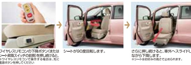
ワイヤレスリモコンの下降ボタン(またはシート昇降スイッチの前部)を押し続けると、ワイヤレスリモコンで操作する場合は、先に電源ボタンを押してください
